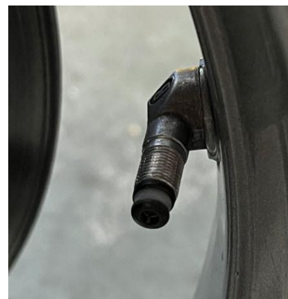
El vástago interno de la válvula retrocedió.
